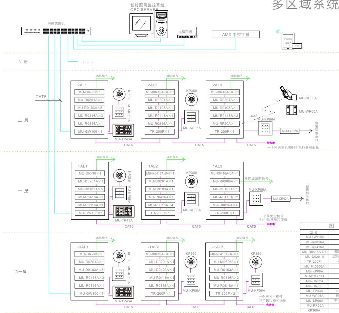
图例为MU-BUS总线系统拓扑图（多区域组网）示意，每个区总线设备需在64个内（不含主机、电源、耦合器等无地址设备），每个区域上层走TCP/IP协议，同一网段最多253个区，该组网方式适合大范围区域使用，如：高层办公楼公共区、主题公园等；
