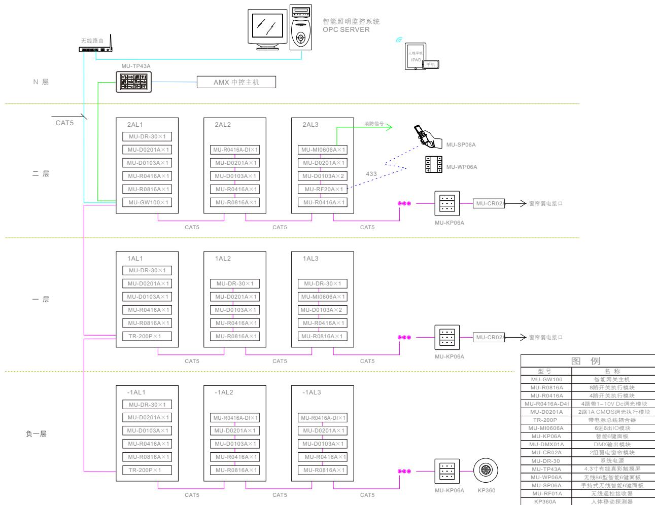
图例为MU-BUS总线系统拓扑图（单区域组网）示意，总线设备需在64个内（不含主机、电源、耦合器等无地址设备），该组网方式适合小范围区域使用，如：展厅、会议室、博物馆、别墅等；
